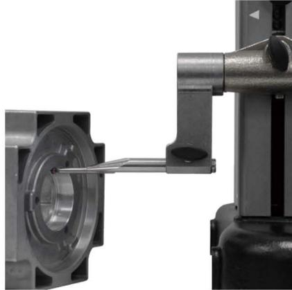
직경 및 직경의 중심값 측정
